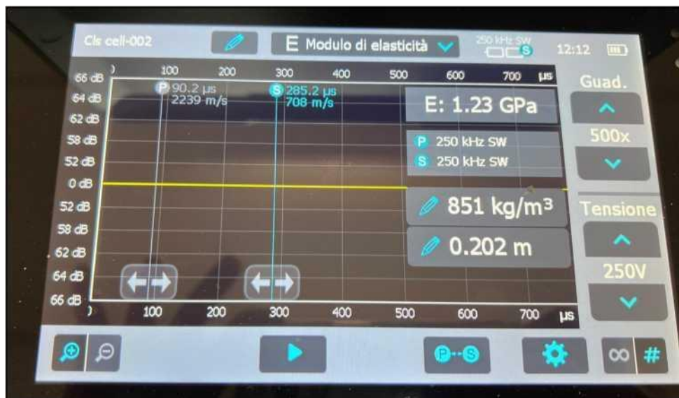
Figur 15. Exempel på ett prov som analyserats med ultraljudstestning
