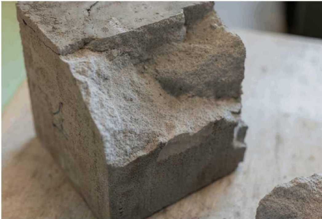
Figur 14. Provfel under tryckhållfasthetstestning
