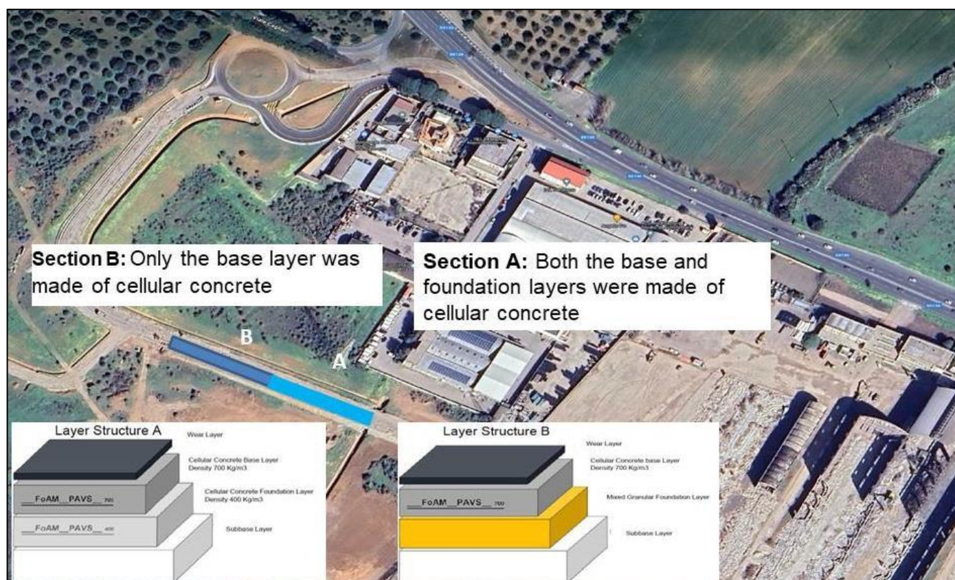
Figur 2. Lagerstruktur för försöksavsnittet
