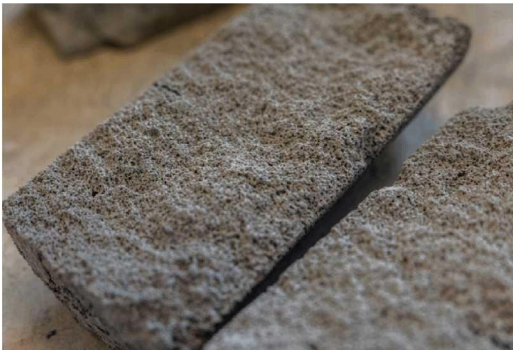
Figur 13. Provfel under direkt draghållfasthetstestning
