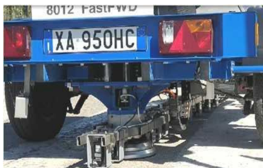
Figur 17. Lastplatta och avböjningssensorer monterade på sensorstången
